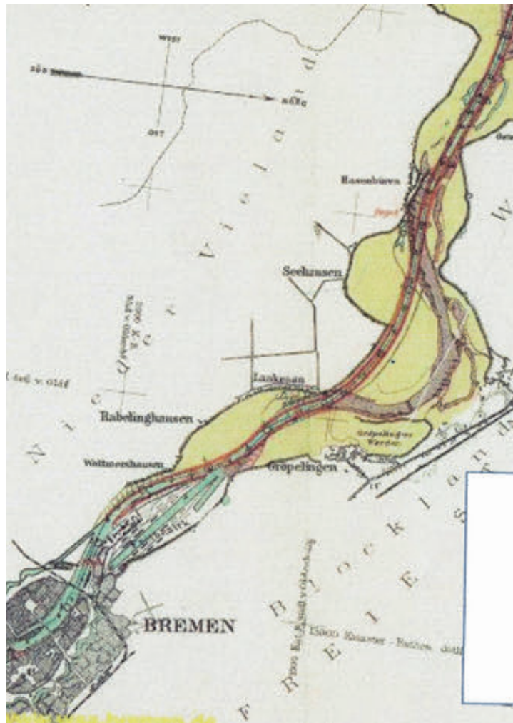
Abb. 2. „Lange Bucht“ mit Planung 5 m-Ausbau.
