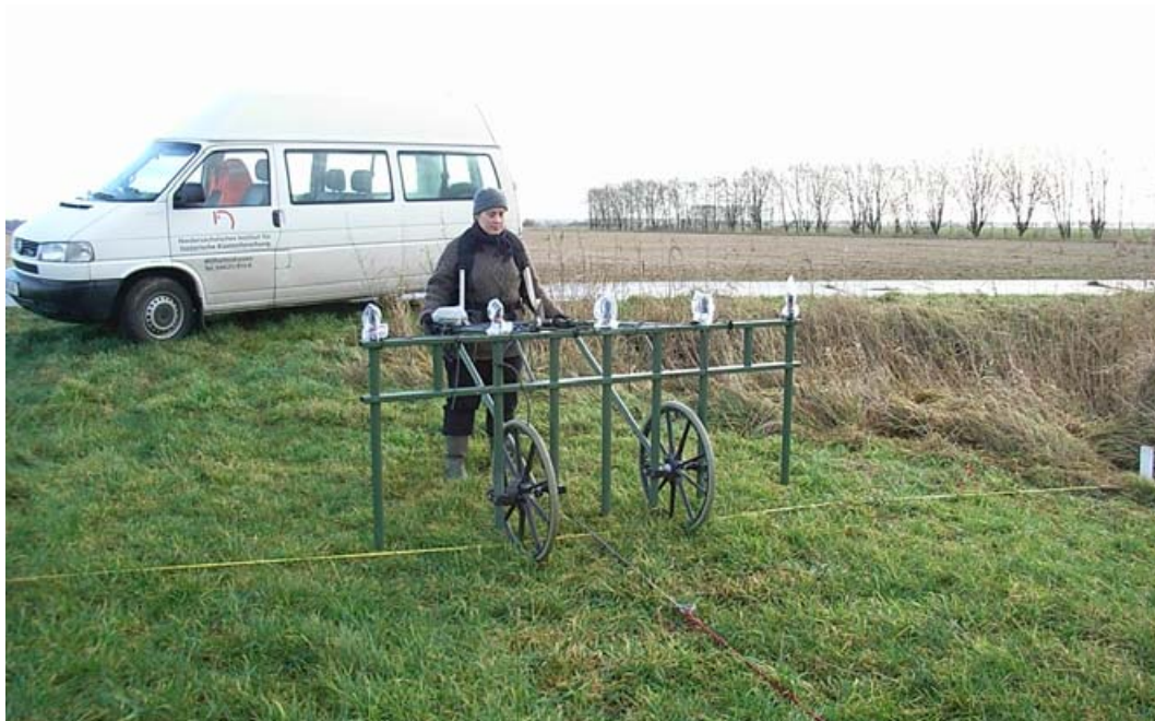
Abb. 11. Geomagnetische Messungen mit dem 5-Sondengerät der Römisch-Germanischen Kommission in Frankfurt am Fundplatz Wurthfleth "Neue Hellmer", Ldkr. Cuxhaven (Foto: M. Müller).
