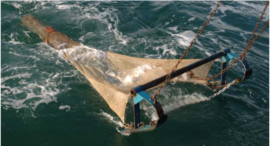
Abb. 3. Eine 2 m Kurre für die Beprobung der Epifauna.
