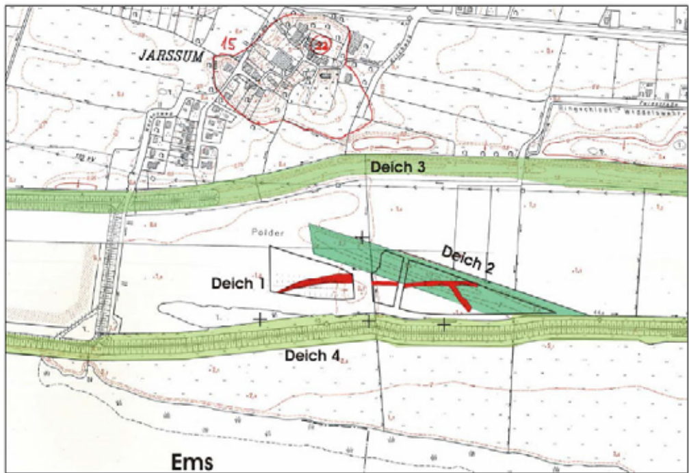
Abb. 1. Stackdeich Jarssum: Lageplan der historischen Deichlinien 1-3 und der aktuellen Seedeichlinie 4 (Grafik: S. König, Ostfriesische Landschaft).
