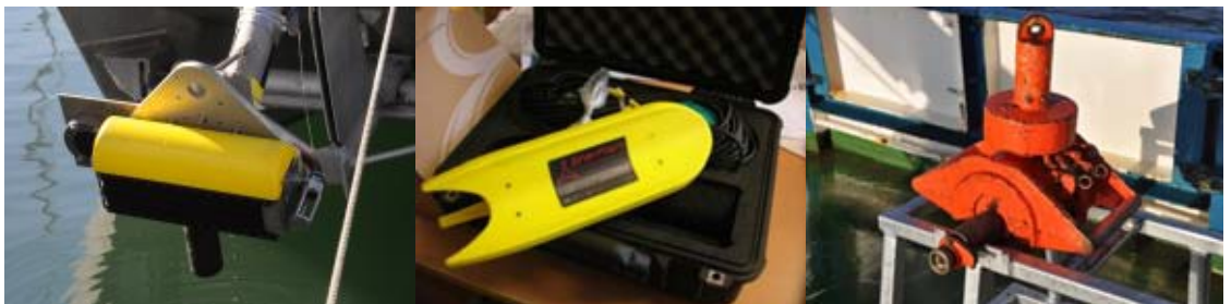
Abb. 2. Hydroakustische Messgeräte Fächerecholot (links), Seitensichtsonar (Mitte) und Bodengreifer – Shipek – (rechts).
