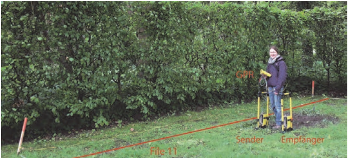
Abb. 4. Messfeld und Position von GPR-File 11. Anordnung von Sende- und Empfangsantenne (200 MHz) des PulseEKKO GPR-Systems (Foto: Tanja Tillmann).
