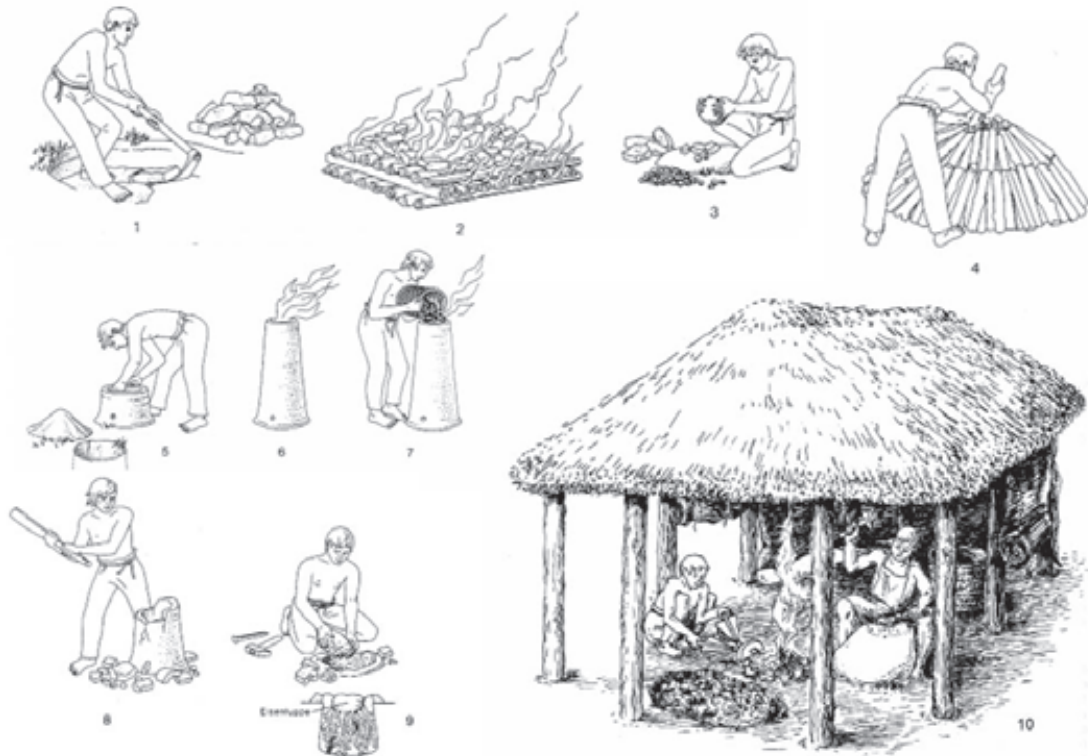
Abb. 4. Arbeitsschritte vom Erz zum Metall während der Römischen Kaiserzeit: 1-3 Herausbrechen, Rösten und Zerkleinern (Pochen) von Raseneisenerz, 4 Herstellung von Holzkohle in Platz- oder Grubenmeiler, 5-7 Bau und Betrieb eines Rennfeuerofens mit Schlackengrube, 8-9 Entnahme der Eisenluppe, 10 Weiterverarbeitung der Luppe in der Schmiede (nach Jöns 1997 mit Ergänzungen).
