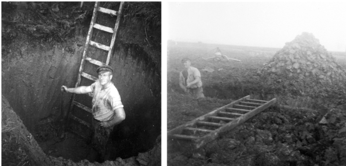
Abb. 4. Der Handkuhler Fritz Ehlen bei der Arbeit. Der in der Grube abgestochene Klei wird auf Haufen gesammelt (Fotos: Archiv Jörg Petersen).
