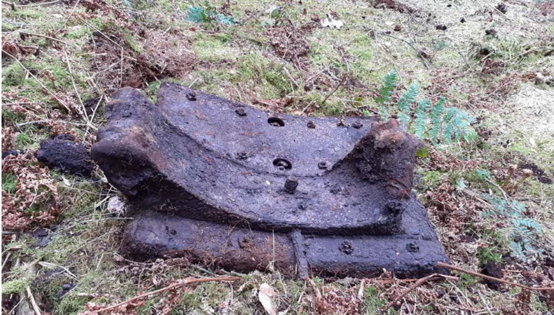
Abb. 6 Schlitten als hintere Auflage für die Fi 103 aus dem Stüh (Foto: M. Kiesner).
