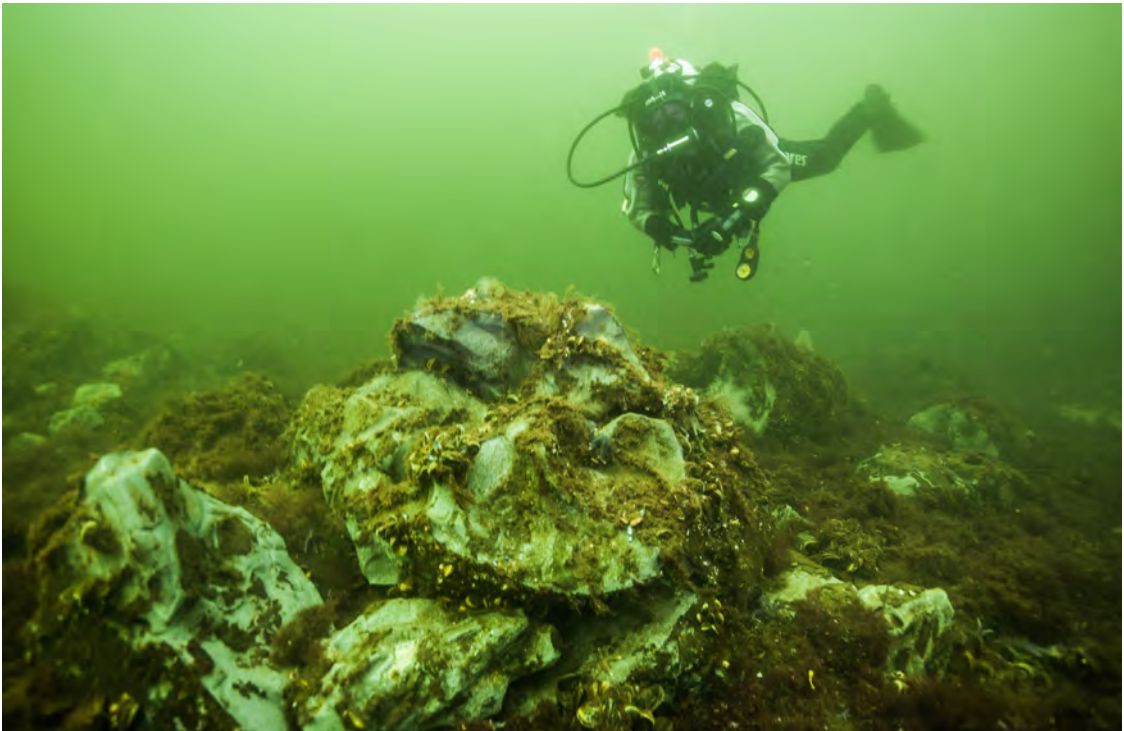
Abb. 1. Schießwollebrocken im Munitionsversenkungsgebiet Kolberger Heide/Ostsee. © GEOMAR/Jana Ulrich.
