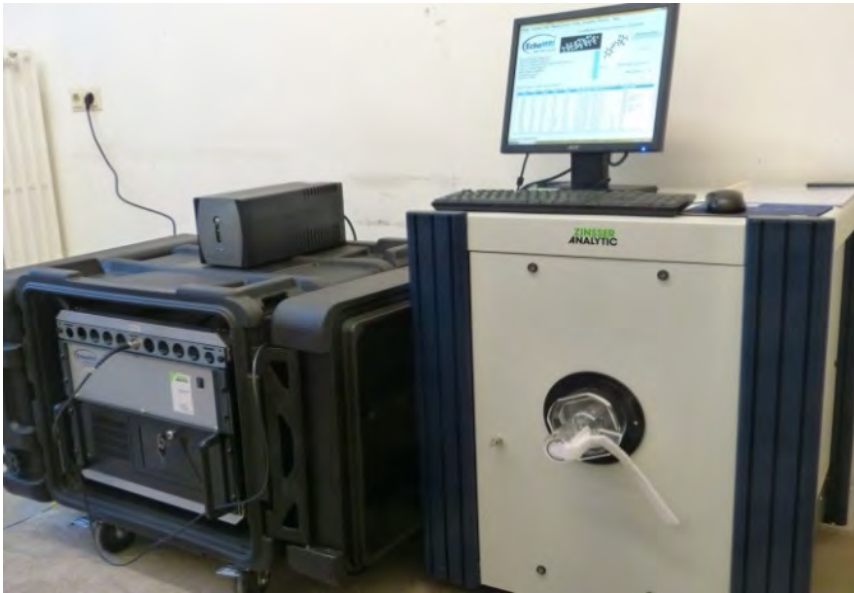
Abb. 2. Ganzkörperscanner EchoMRI® für Vögel, bestehend aus dem Messgerät mit eingeschobener Messröhre (rechts) und dem Rechner (links). Foto: F. Bairlein.
