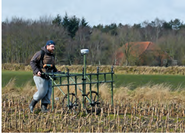
Zu den Aufgaben der Nachwuchsforscher gehört es auch, geomagnetische Messungen mit einem Messwagen durchzuführen.
