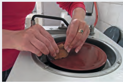
Schleifen einer Keramikprobe für die mikroskopische Untersuchung.
